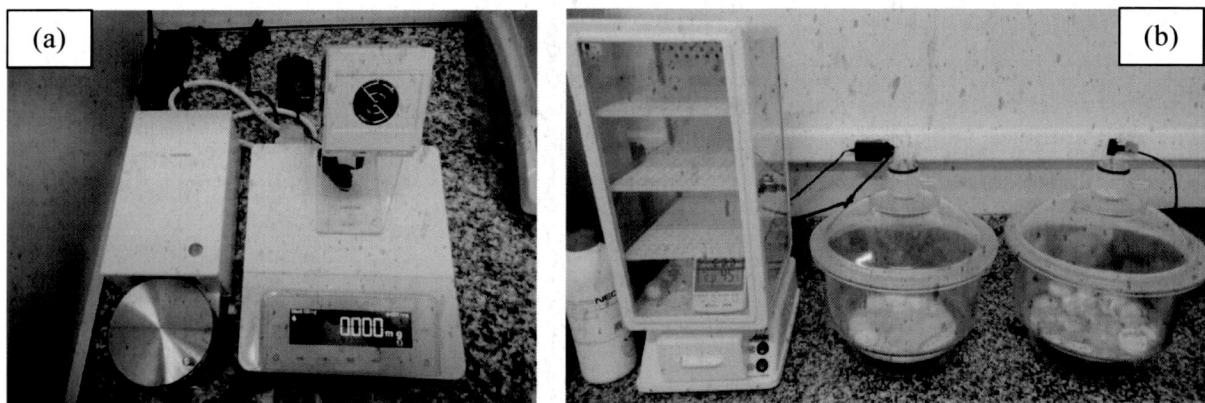
Figura 4-5. (a) Microbalança Sartorius MSE6.6S; (b) dessecadores.
