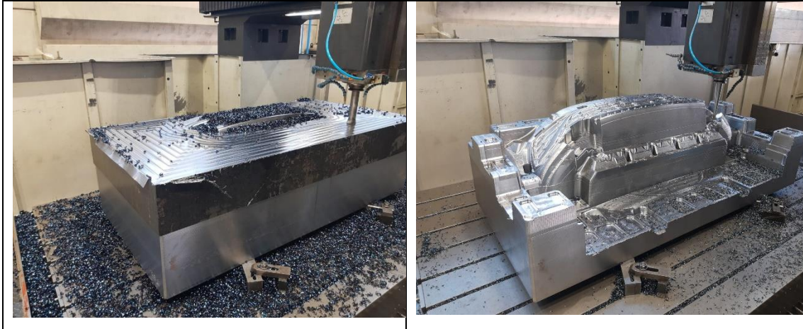
Figura 01: Usinagem de bloco de aço, evidenciando o trabalho de desbaste.
