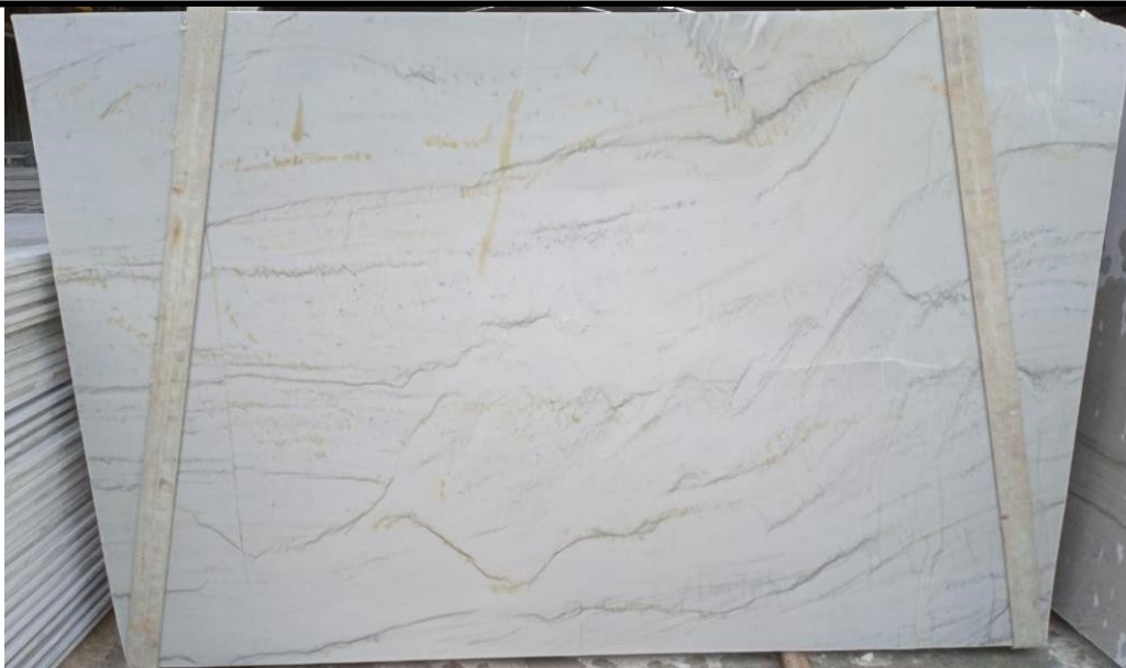
Figura 4. Chapa de Mont Blanc (MB) com grau de oxidação de médio para forte.
