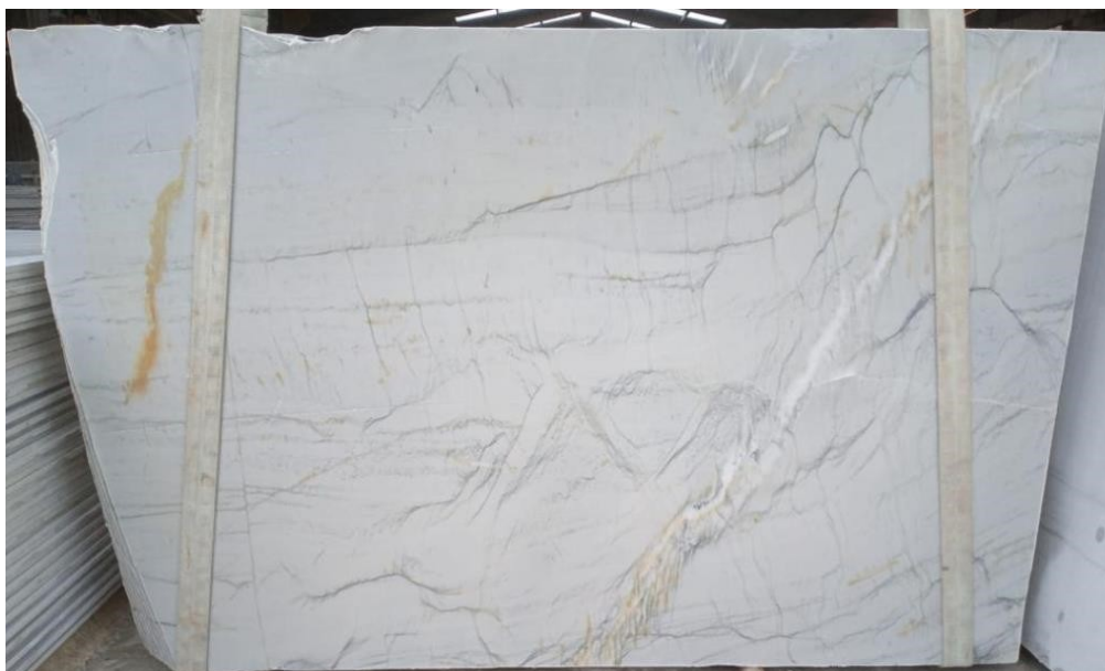
Figura 5. Chapa de Mont Blanc (MB) com alto grau de oxidação.
