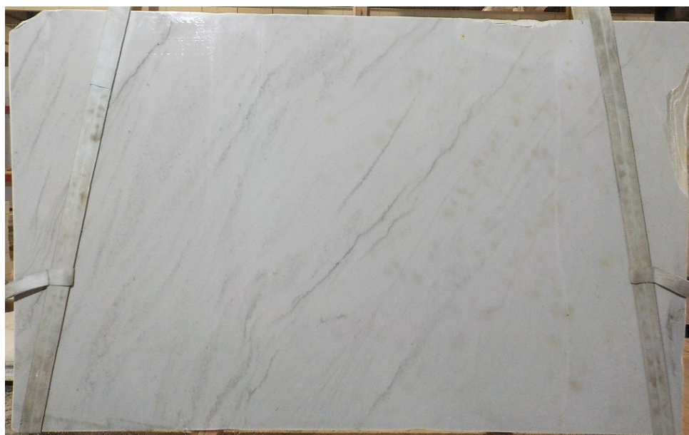
Figura 3. Chapa de Mont Blanc (MB) com grau médio de oxidação.
