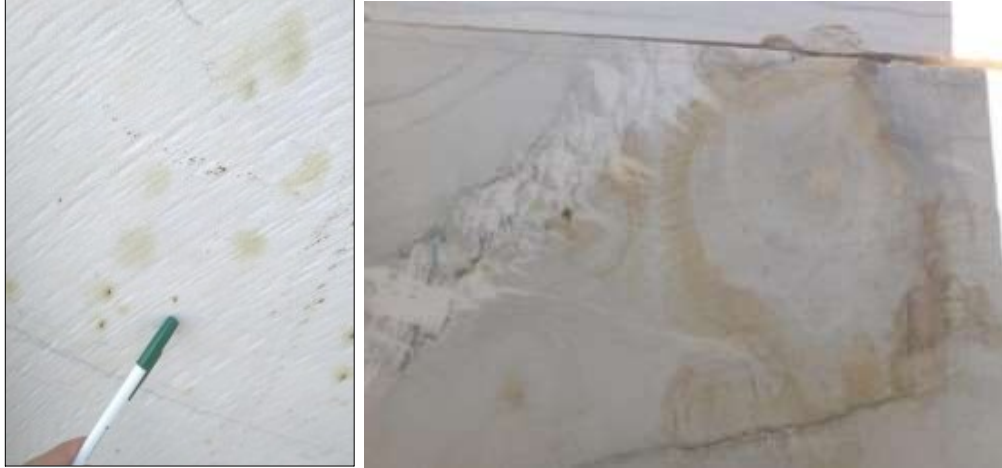
Figura 1. Manchamentos em quartzito provocados por oxidação de piratas (à esquerda) e por percolação de água rica em ferro (à direita).
