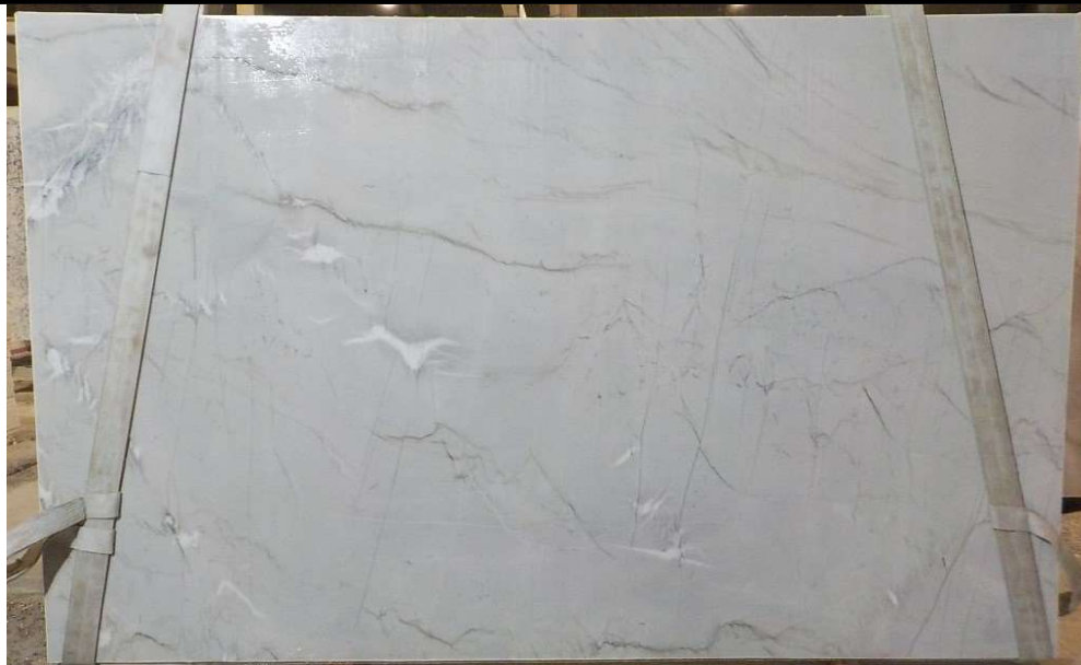
Figura 2. Chapa de Mont Blanc (MB) sem oxidação, que tipicamente recebe tratamento ácido preventivo.
