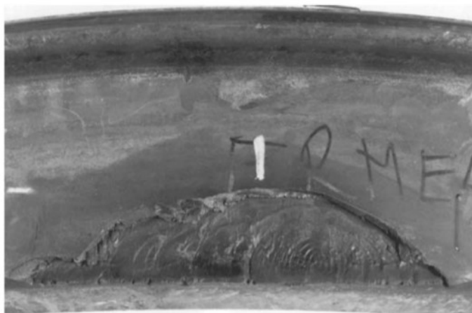
Figura 8. Superfície de fratura correspondente ao defeito spread rim , desenvolvido a partir de trincas desenvolvidas na borda da pista de rolamento provenientes de escoamento da bandagem. Fonte: [12].
