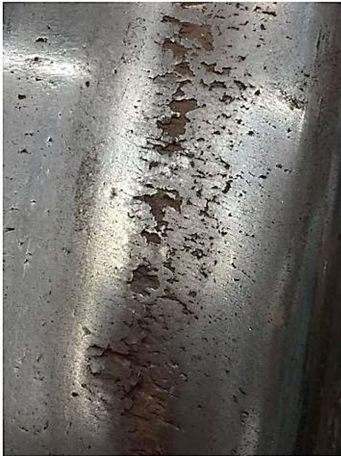
Figura 4. Defeito do tipo shelling na pista de rolamento de uma roda ferroviária. Fonte: autor.
